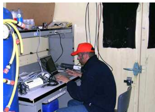
.Laurent programme une sonde. Il lui indique le type de mesures à faire, leur fréquence et pendant combien de temps. Cette sonde sera ensuite mouillée dans un de nos trous dans la banquise
