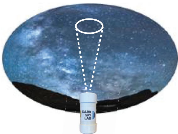
Fig.1 - Mesure de la luminosité par un capteur Ninox
