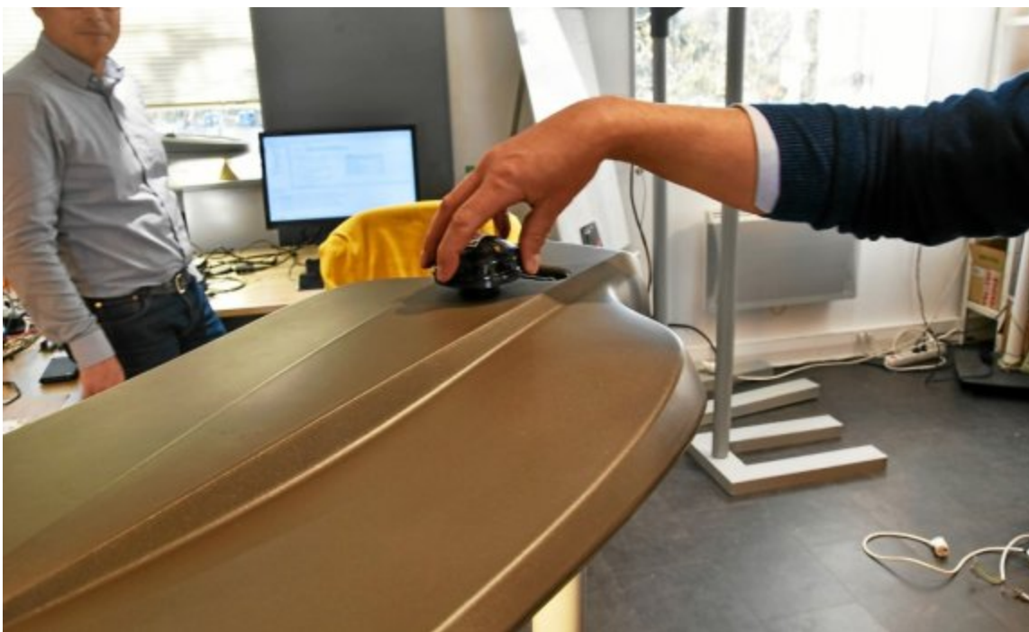
Exemple de module que la PME quimpéroise Nexiode connecte à des luminaires afin de contribuer à mieux réguler l'éclairage public. (Le Télégramme/Bruno Salaün)
