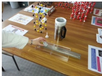
Expérience de lévitation d'un aimant sur un matériau supraconducteur
