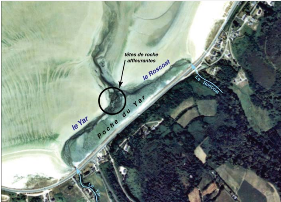
Configuration du site avant la rectification des cours d'eau (été 1996) : présence de la confluence des deux filières et des têtes de roche affleurantes dans la poche du Yar.
