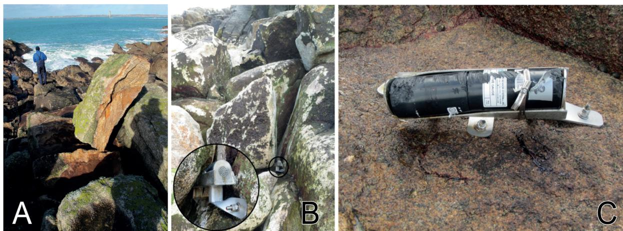
Figure 4 - Endommagement des capteurs durant l'hiver 2013/2014. A) Blocs de plusieurs tonnes arrachés et/ou déplacés. B) et C) Capteurs écrasés et/ou endommagés par la projection de blocs.
