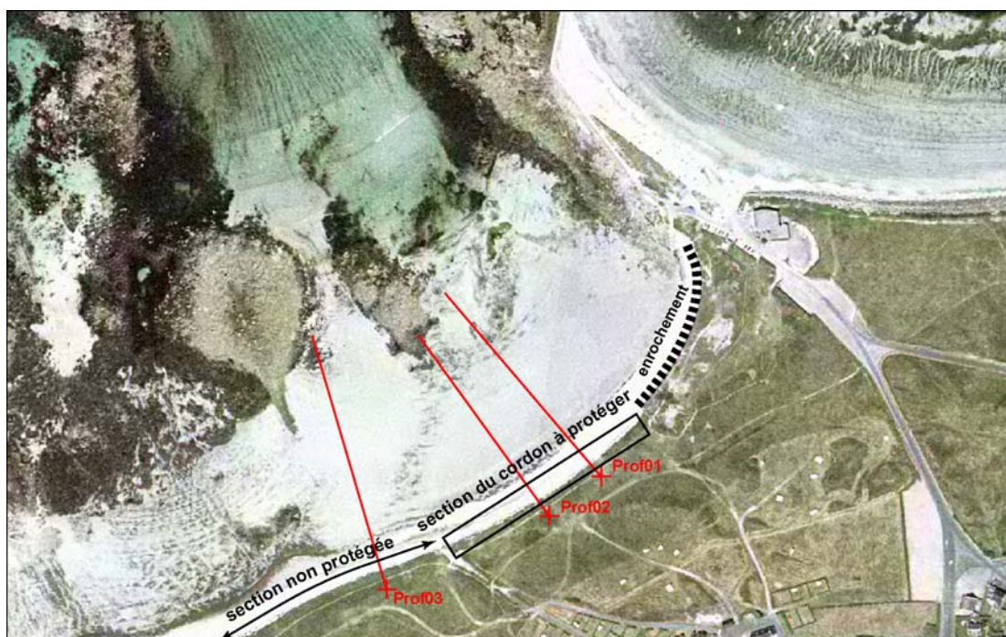
Figure 4 – Localisation des profils de mesures topo-morphologiques en fonction des sections du cordon dunaire à protéger et non protégée
