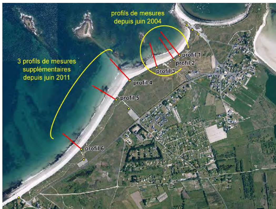
Figure 2. Localisation des six radiales de mesures de profils de plage / dune sur le site du Vougot.
