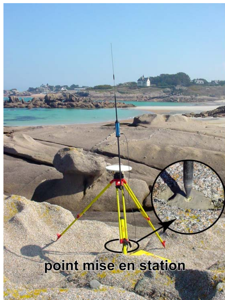
Photo 3 – Point de mise en station du DGPS sur les têtes de roche situées entre les plages de la Grève Rose et de la Grève Blanche (cliché Suanez et Fichaut 31/03/2009)
