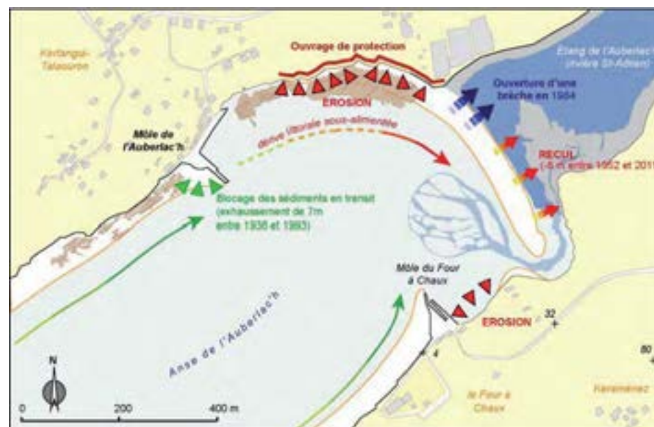
Figure 60 : Impact du môle de l'Auberlac'h sur le fonctionnement morphosédimentaire des plages avoisinantes et de la flèche littorale.
