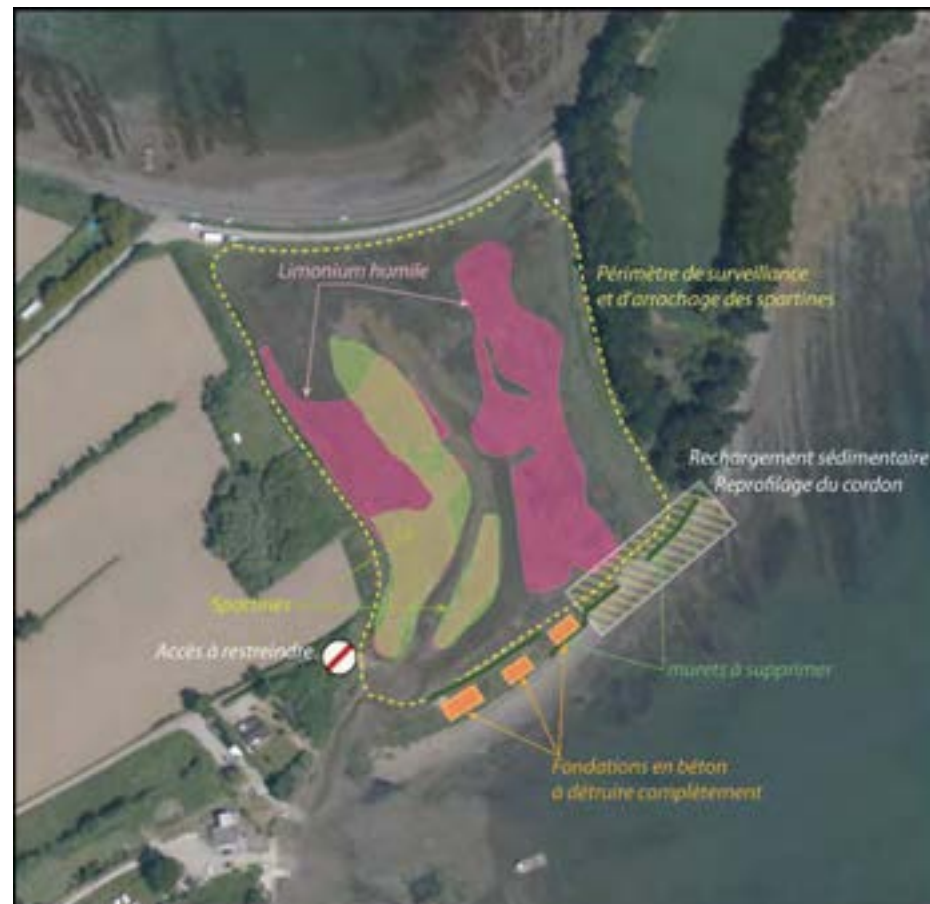
Figure 38H : Actions de conservation et de restauration préconisées sur le site du Renard.
